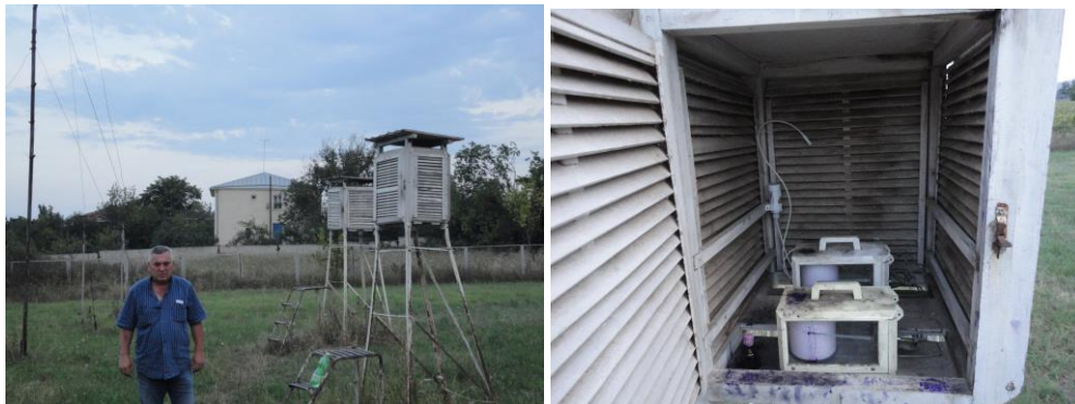
ნახ. 2 სარეჟიმო აპარატურის მონტაჟი თელავის მეტეოსადგურზე
